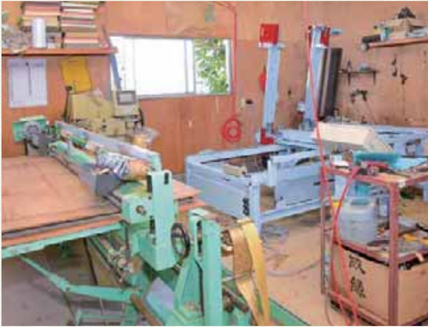
いぐさの香りに包まれる作業場。畳の切断や縫着などに用いる畳製造機械が並ぶ。へりに使われる畳縁の布が煌びやか。
